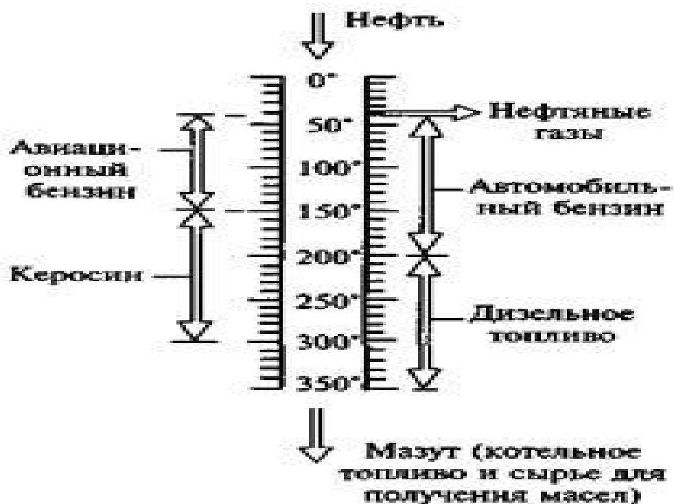
Схема 2. Принципиальные схемы получения важнейших видов топлива для двигателей при перегонке нефти
