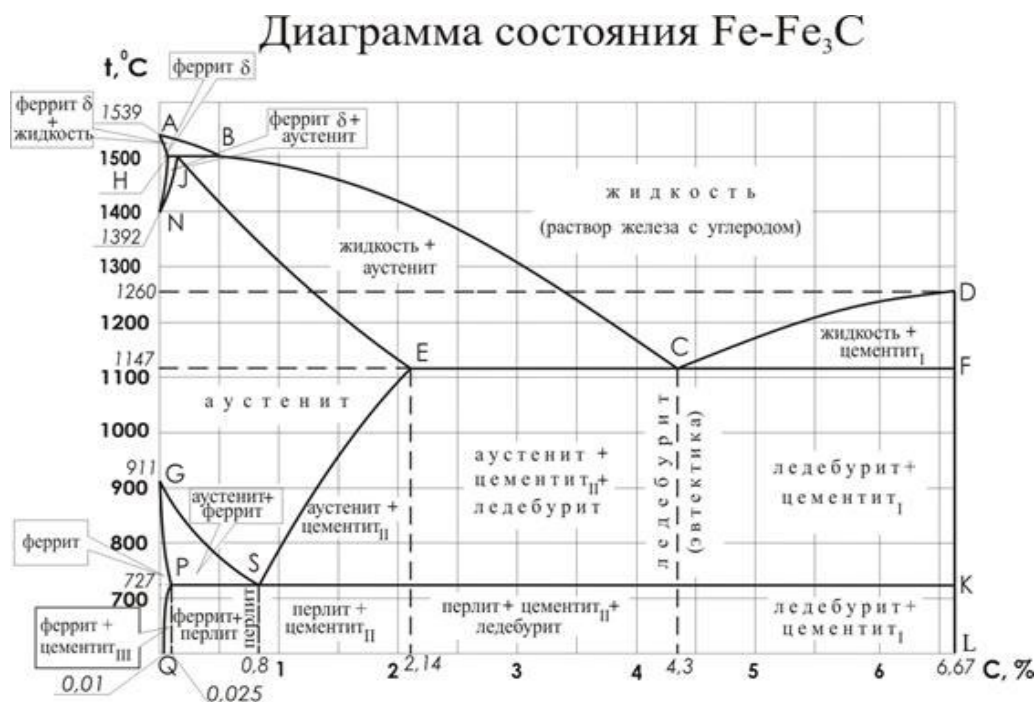
Рис.2. Структурная диаграмма Fe-C сплавов
