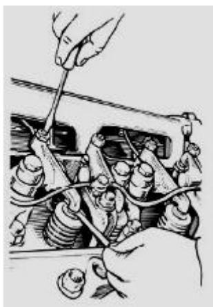
Рис.1. Регулировка зазора клапанного механизма ЯМЗ-236
